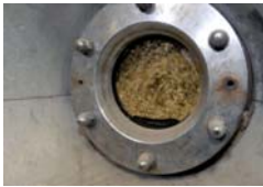
Schnitzelmasse im Extraktionsturm
