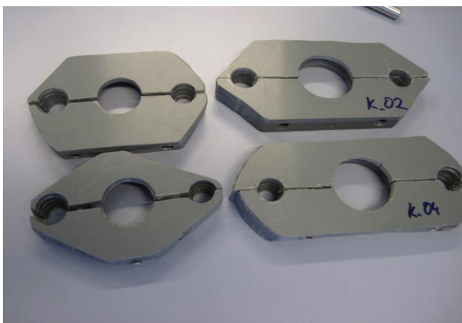
Abbildung 1: Halterungsprototypen für die Messelektroden
